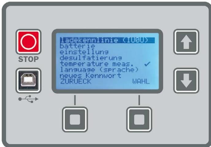
Die Ladeparameter können einfach durch Taste direkt im Menü am Ladegerät eingestellt werden – der Ladevorgang wird den Bedürfnissen der jeweiligen Batterie angepasst.
